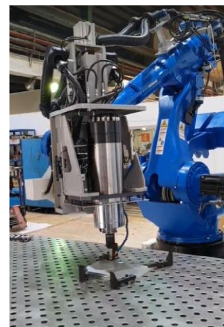
具高荷重機械手臂摩擦攪拌銲接系統(600公斤級) 3D複雜曲面
